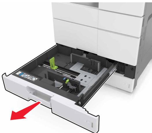
2 压住纸张导片，并将导片滑动到与加载的纸张尺寸相符的正确位置上。
