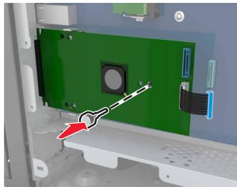
**5** 使用螺钉将 ISP 安装支架安装到控制器板罩上。
