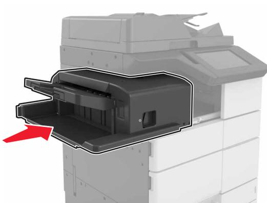
**[x] 页卡住，打开盖门 H 并顺时针旋转旋钮 H6。将纸张留在接纸架中。[426.xx - 428.xx]**
