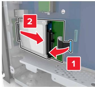
**4** 将 ISP 安装在之前硬盘在控制器板上的相同位置中。
