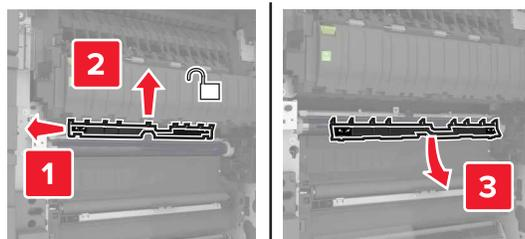
6 使用手柄抬起转印模块，然后将它完全拉出。
