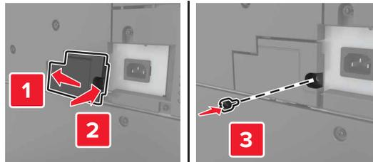
**12** 将电源线连接到打印机和电源插座上。
