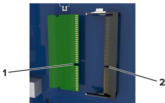
4 将内存卡笔直推入连接器中，然后将卡朝着控制器板墙推，直到它发出 *咔嗒* 一声，卡入到位。
