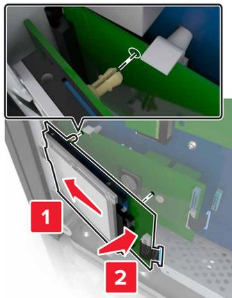
8 将硬盘接口电缆的插头插入 ISP 上的连接器中，然后将 ISP 解决方案接口电缆连接到控制器板的插座中。
