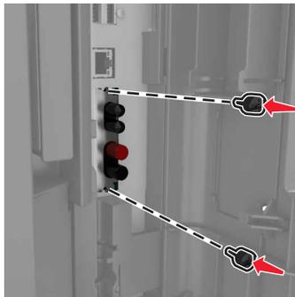
**6** 移除将硬盘安装支架安装到硬盘上的翼形螺钉，然后移除支架。
