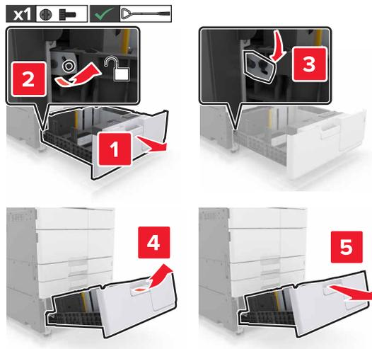
**3** 打开盖门 C。确保它不触及任何连接到打印机的电缆。
