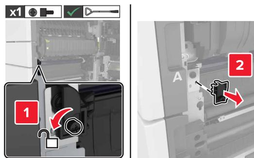
4 松开转印模块锁的螺钉。
