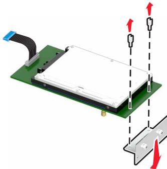
7 将硬盘的螺孔与 ISP 上的孔对齐，然后向下压硬盘，直到螺孔发出 *咔嗒* 一声，卡入到位。
